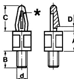
\* Foro per fissaggio:  $\varnothing 4$  mm
