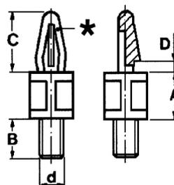
\* Foro per fissaggio:  $\varnothing 4$  mm
