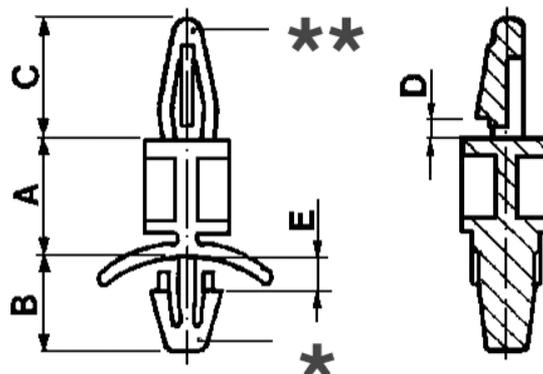
\* Foro per fissaggio:  $\varnothing 4.75$  mm
