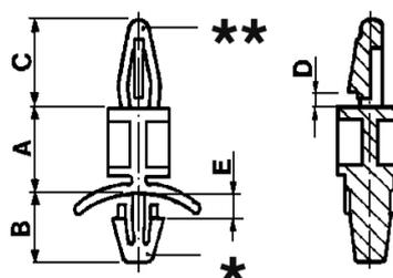
\* Foro per fissaggio:  $\varnothing 4.75$  mm
