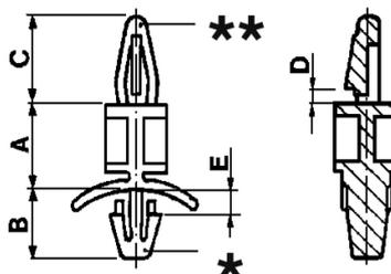
\* Foro per fissaggio:  $\varnothing 4.75$  mm
